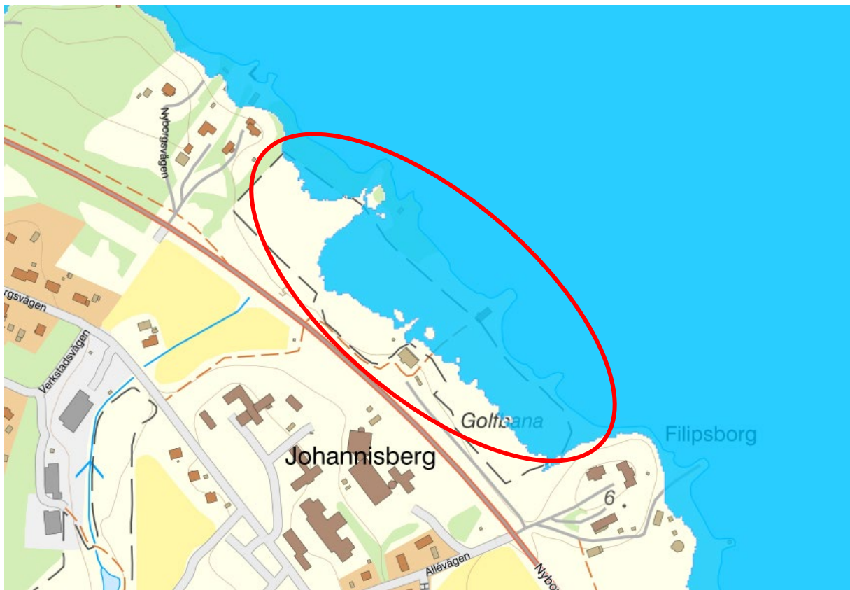
Figur 9. Översvämmat område vid ett klimatanpassat 100-årsflöde. Källa: MSB, översvämningportalen, 2025-05-13.
