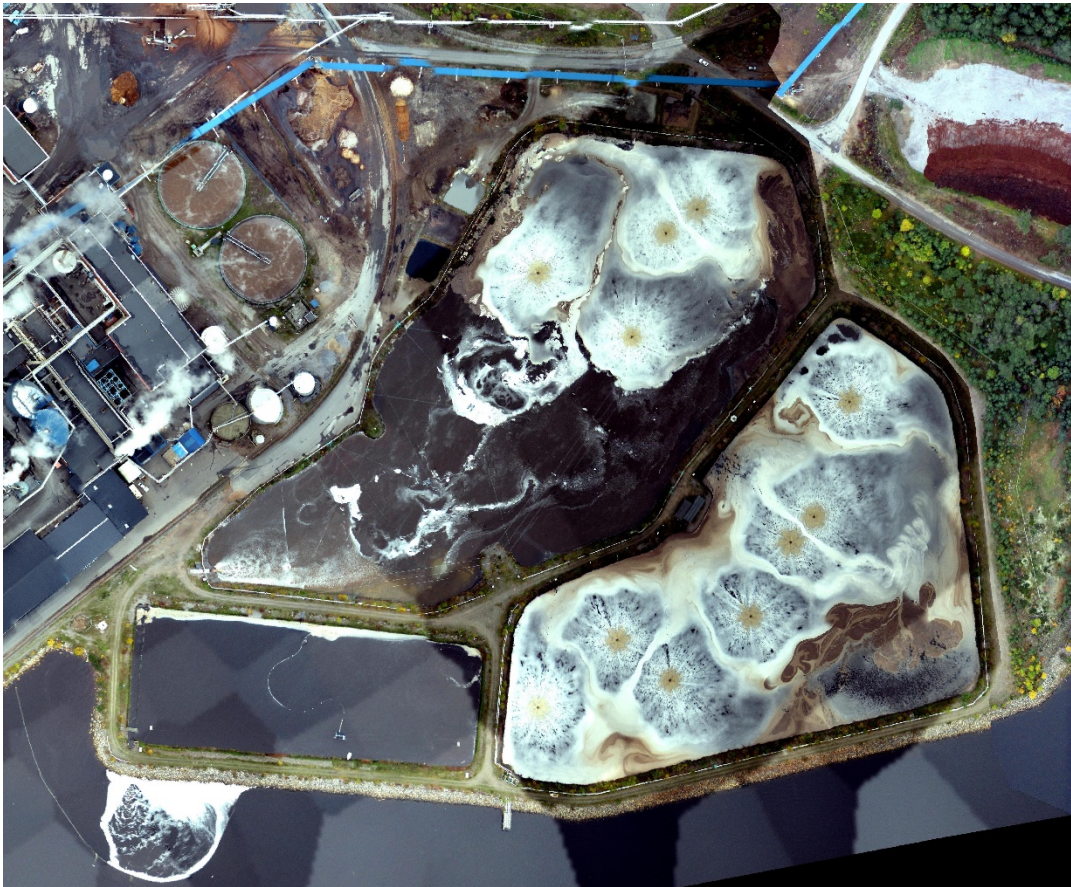
Figur 4. Luftad damm samt eftersedimentering som utgör den reningen av rejektvattnet från fabriken.
